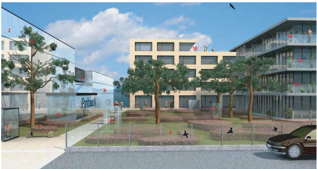
Übersicht über Gefahrenstellen in einer zeitgemässen Überbauung: 1 Fahrradunterstand in transparentem Material, 2 spiegelnde Fassaden (Glas, Metall etc.), 3 Bäume vor spiegelnden Fassaden, 4 attraktive Grünflächen vor spiegelnden Fassaden, 5 transparente Lärmschutzwand mit unwirksamen schwarzen Silhouetten, 6 verglaster Tiefgaragenaufgang, 7 transparente Fussgängerbrücke, 8 spiegelnde Fassade, 9 Gartenskulpturen aus spiegelndem oder transparentem Material, 10 transparenter Eckbereich, 11 Wintergarten, 12 Balkongeländer aus Glas, 13 transparente Eckbereiche, 14 Pflanzen hinter transparenten Flächen. Wie dieselbe Überbauung vogelfreundlicher gestaltet werden kann, siehe S. 15.
